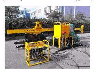
Серия подземных буровых станков «UTU-200», «UTU-500», «UTU-700» и прочих модификаций имеет верхний гидравлический привод высокой мощности и используется для геологоразведочных работ в подземных /стесненных условиях. Многоплашковый зажимной патрон.
